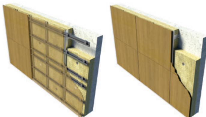
Blinde mechanische bevestiging op aluminium of stalen achterconstructie
